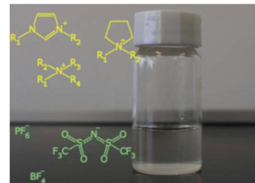
図 代表的なイオン液体の化学構造と外観 出展：兵庫県立大大学院 化学工学専攻 柿部助教
